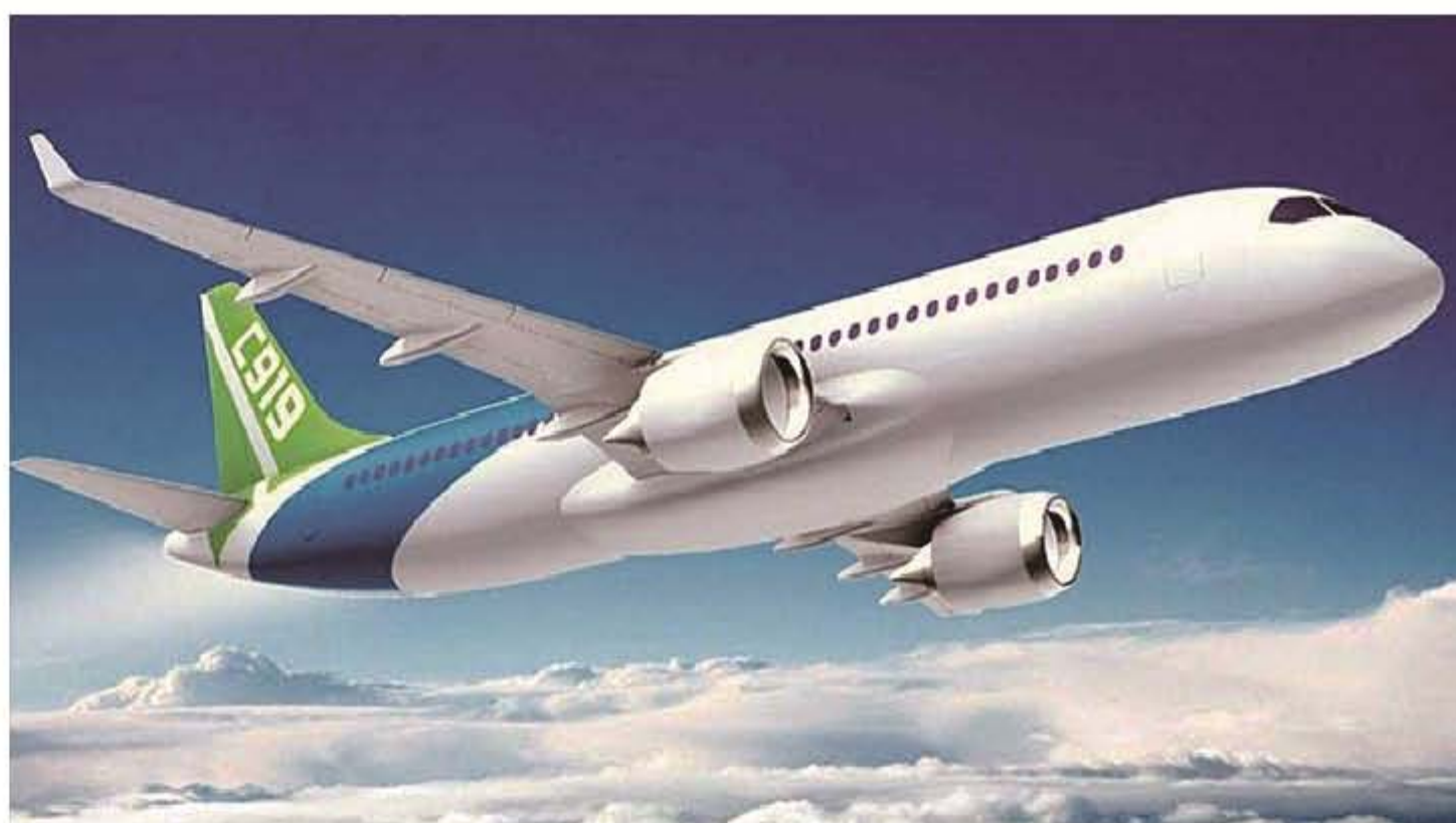
MERICAN 3768高性能环氧树脂应用 升降舵、前后缘舱、方向舵、扰流板、整流罩等次承力结构
